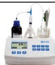
HI84532 misura la concentrazione di ioni idrogeno titolabili contenuti nei campioni di succhi di frutta attraverso neutralizzazione a pH fisso con una soluzione fortemente basica.
